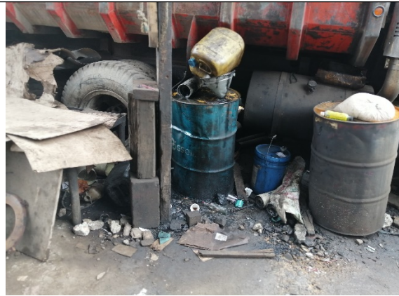
Fotografía 4. Caneca de 55 galones para el almacenamiento de aceite usado, en mal estado y presencia de manchas de hidrocarburo sobre el suelo de relleno.
